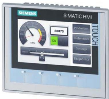
SIMATIC HMI KTP400 Comfort, Comfort Panel, manejo con teclado/táctil, pantalla panorámica TFT 4", 16 millones de colores, interfaz PROFINET, interfaz MPI/PROFIBUS DP, memoria de configuración de 4 MB, Windows CE 6.0, configurable a partir de WinCC Comfort V11
